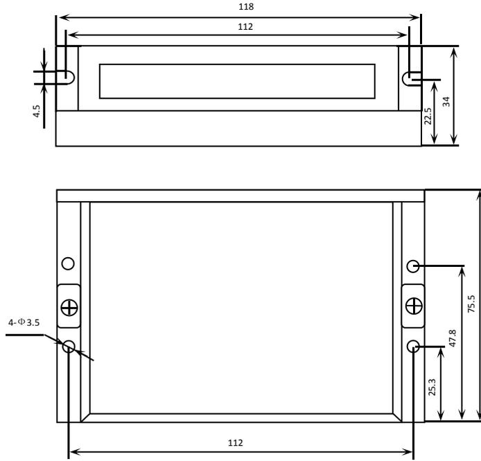
图 1 安装尺寸图(单位: mm)
